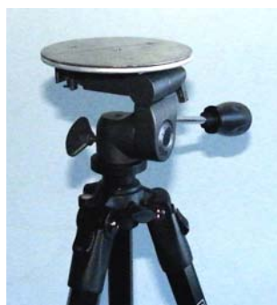
Plaque métal pour fixation sur trépied recevant la base aimantée de la caméra
