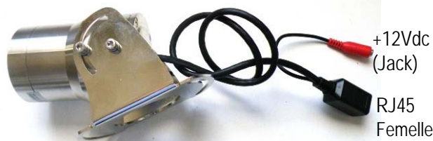
Un connecteur jack 2.1 est présent afin d'alimenter la caméra en 12VDC dans le cas où l'on ne dispose pas de PoE sur le câble réseau
