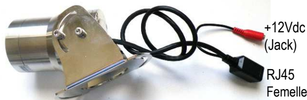
Cordon standard: Un connecteur jack 2.1 est présent afin d'alimenter la caméra en 12VDC dans le cas où l'on ne dispose pas de PoE sur le câble réseau
