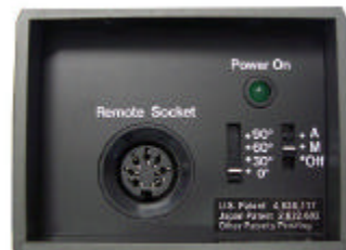
Face arrière avec connecteur de télécommande et commutateurs M/A + fonction autopan
