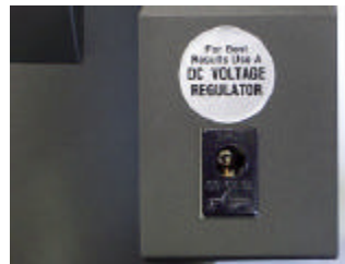
Connecteur Jack 2.1 pour entrée d'alimentation 6 VDC externe et logement de piles pour alimentation interne (longue autonomie)
