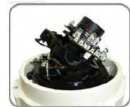
Platine d'orientation 3 axes : image droite quelque soit le support
