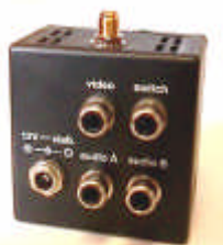
Mini TX version DX avec connecteur SMA pour antenne externe
