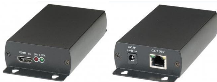
Récepteur HE03LR : face avant et face arrière
