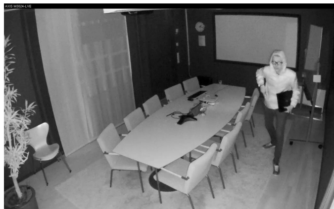
Les images ci-dessus de la caméra AXIS M3024-LVE présentent le même scénario : un homme avec une lampe de poche dans une pièce sombre. Sur ces images, nous pouvons constater la différence qu'offre l'éclairage IR en matière de surveillance dans l'obscurité. La lumière infrarouge ne peut être perçue par l'œil humain mais est visible par la caméra. Haut : sans éclairage infrarouge Bas : avec éclairage IR
