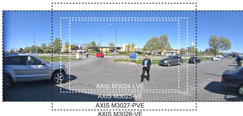
Gauche : angles de prise de vue horizontaux. Droite : champs de vision approximatifs (AXIS M3027-PVE : fixation murale, vue panoramique)
