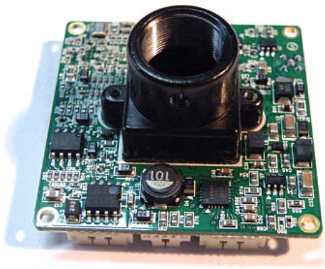
Version standard avec monture M12 x 0.5 pour objectifs Megapixels de la série M13
