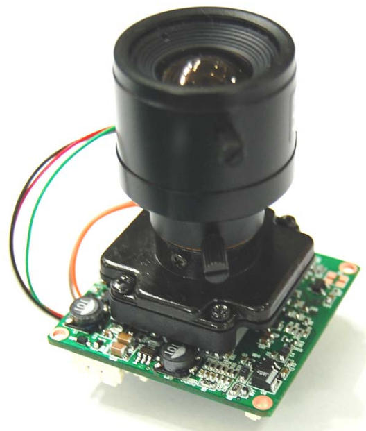
Version Jour / Nuit avec dispositif électromécanique de commutation du filtre IR. Objectif varifocale
